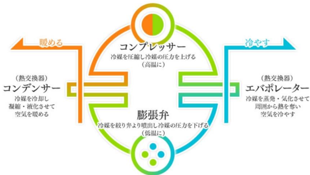
図表2-(1)-1. カーエアコンの基本的な仕組み
