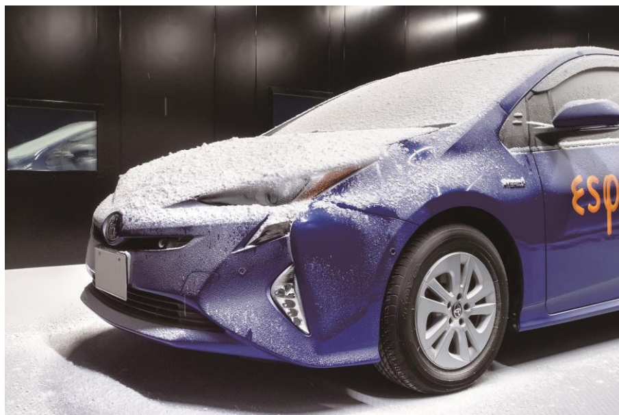
図表1-(1)-3. 「全天候型試験ラボ」では自動車を丸々1台搬入してテストが可能
